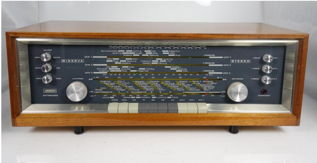
das voll transistorisierte Minerva UKW Steuergerät 675 mit Transistorendstufe.
