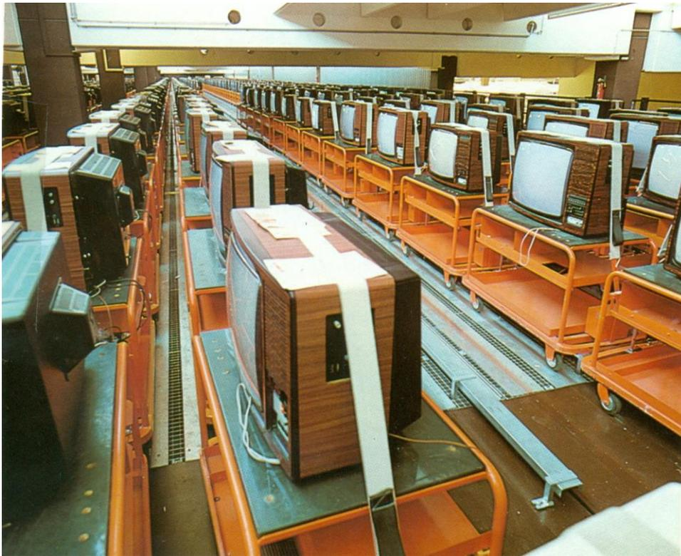
**Farbfernsehgeräte im Dauerlauf- Test**
