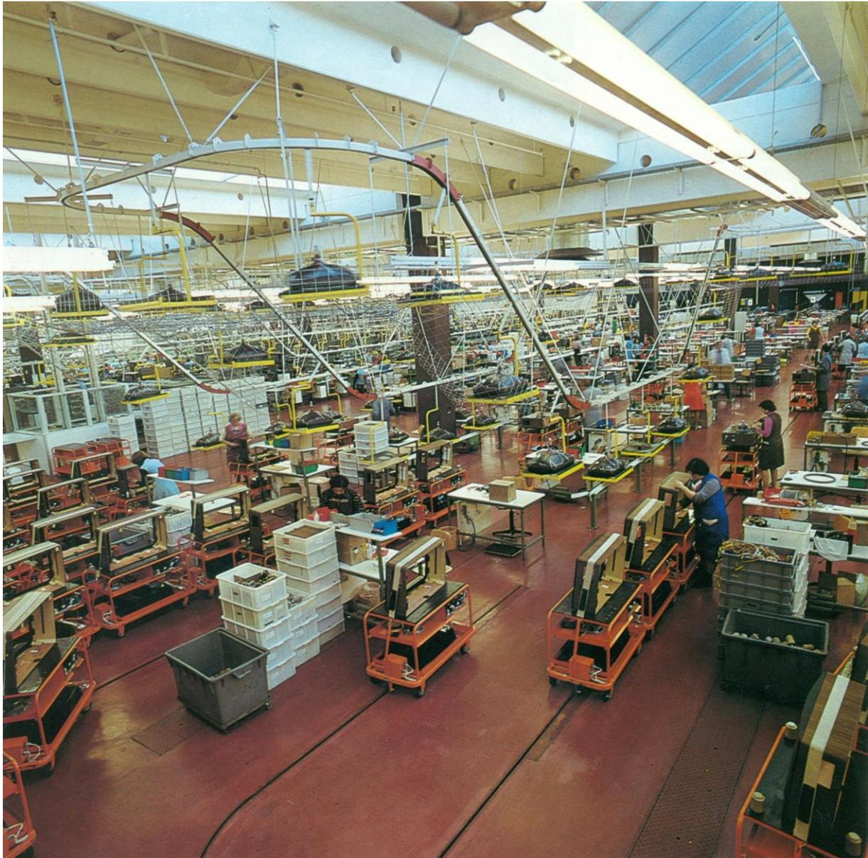
Eine Teilansicht der riesigen Montagehalle im 2. Stockwerk. Man sieht deutlich die an der Decke hängenden Schrägförderer, welche vom Erdgeschoss die Bildröhren anliefern. Im Boden sind die Führungsschienen für die Montagewagen eingelassen. Der Transport wird mit einer Unterflur- Förderkette durchgeführt.
